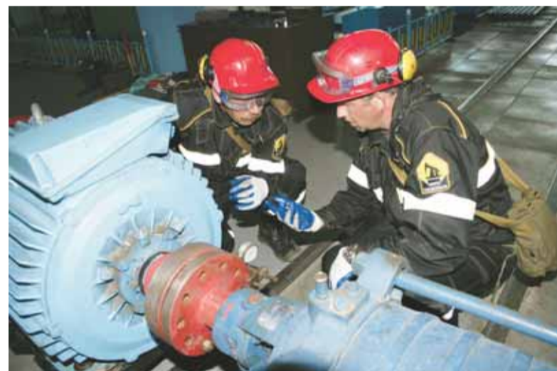
Центровка насоса: главное — точный расчет.
