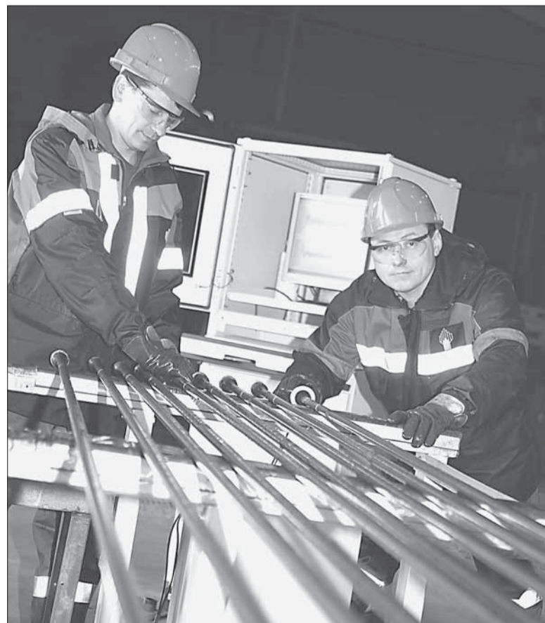
В. Михайлов и Н. Кутлубаев проводят дефектоскопию штанг.
